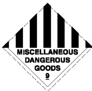
L'etichetta della classe non deve avere una dimensione inferiore a 250 mm di lato e deve essere fissata saldamente al veicolo.
